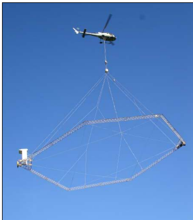
Figur 3.1: Foto af måleudstyr i luften under dataindsamling. Fra SkyTEM Survey ApS.
